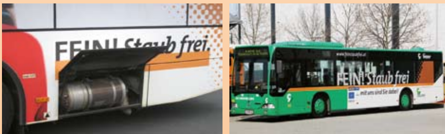
Abb. 9: Eingebaute Partikelabscheidesysteme in Klagenfurter und Grazer Stadtbusse
